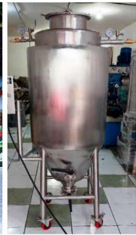
Diseño y construcción de un BIOREACTOR automatizado para elaborar vino para los productores de fresa y mora del cantón Tisaleo
